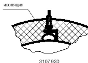
Крепление при помощи металлического уголка
